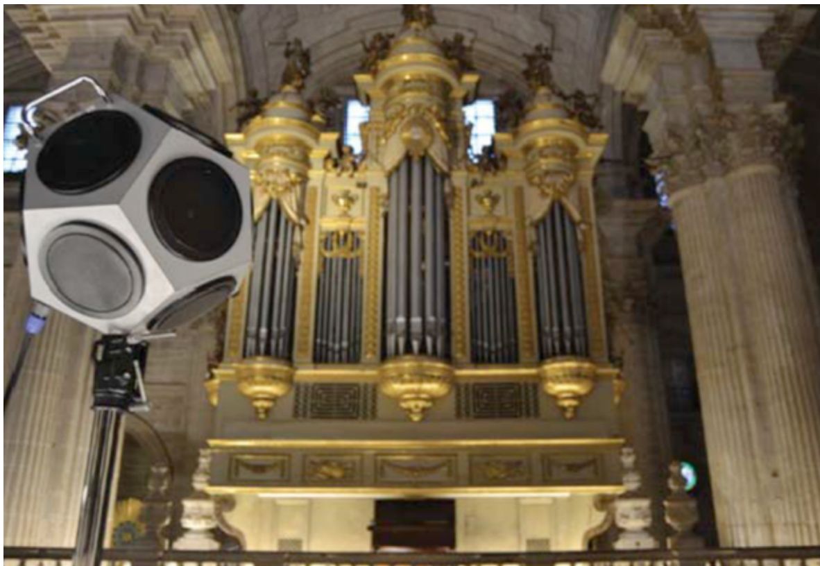
Figura 4. Vista de la fuente sonora empleada en las mediciones acústicas dentro de la Catedral de Jaén (Álvarez-Morales 2013b).
