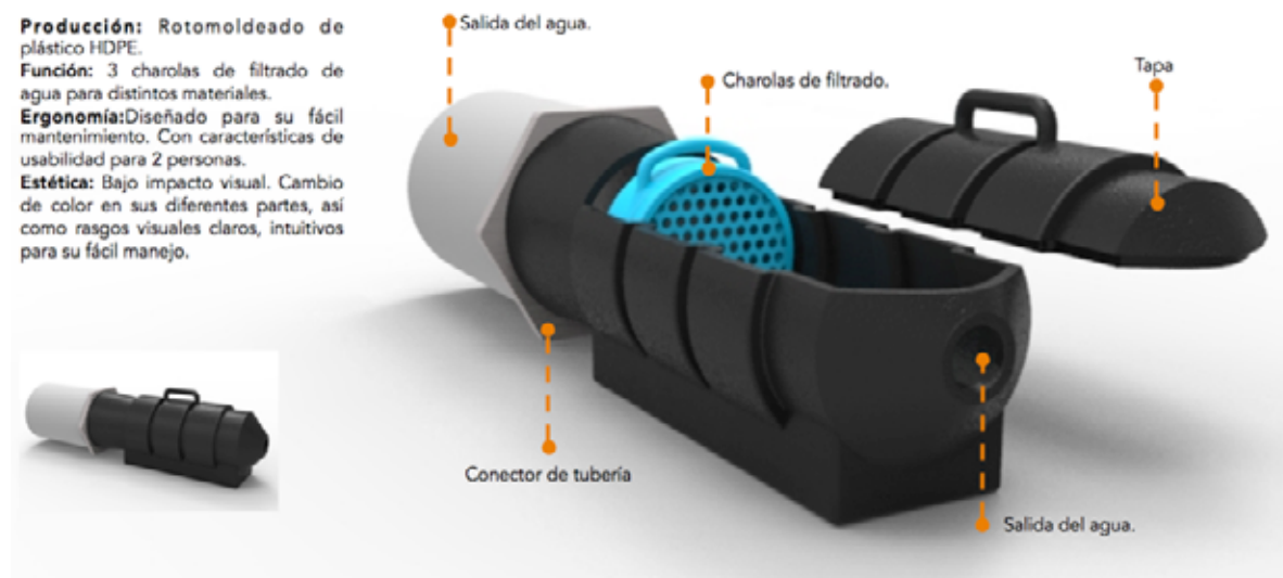
Figura 4. Propuesta de filtro para aguas grises provenientes de asentamientos irregulares en los canales de Xochimilco.
